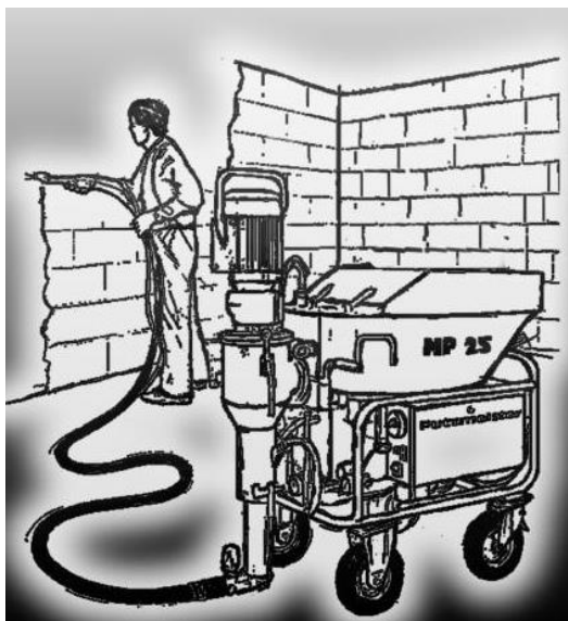
Рис. 5. Процесс нанесения штукатурного слоя
