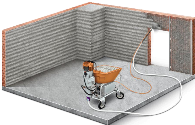
Рис. 2. нанесение штукатурного слоя механизированным способом горизонтально
